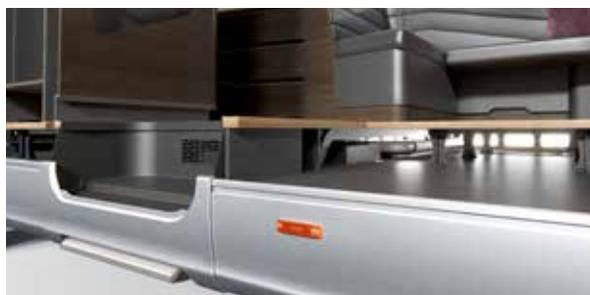
**DOPPELBODEN** \_ Ein durchgängig ebener Boden mit Platz unter dem Fußboden für integrierte Versorgungseinrichtungen, Isolierung und zusätzlichen Stauraum.
